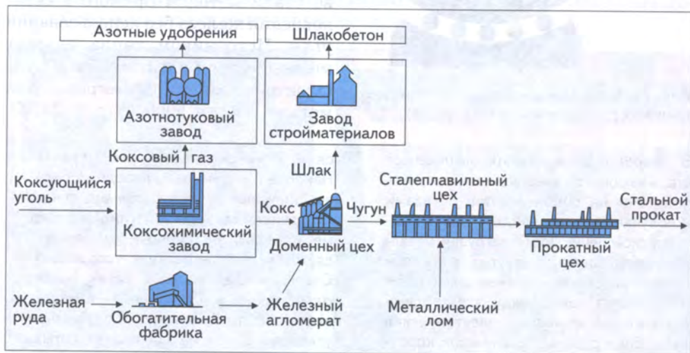
Рис. 28, а. Схема металлургического комбината (доменная металлургия)
